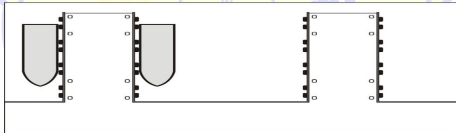
Gambar 2.2 Bentuk Dermaga Jenis Jetty/Pier
