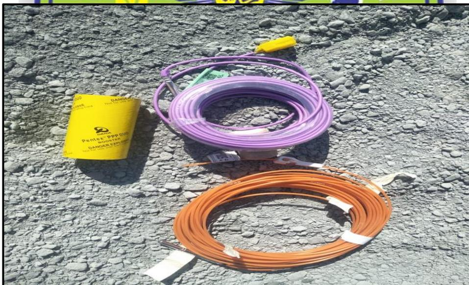
Gambar 2.14 *Booster, Nonel, dan Detonator*
