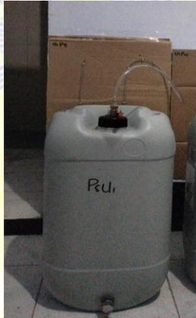
Gambar 2. Reaktor Biogas
