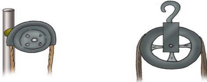
(a) katrol pada tiang bendera (b) katrol pada sumur timba
