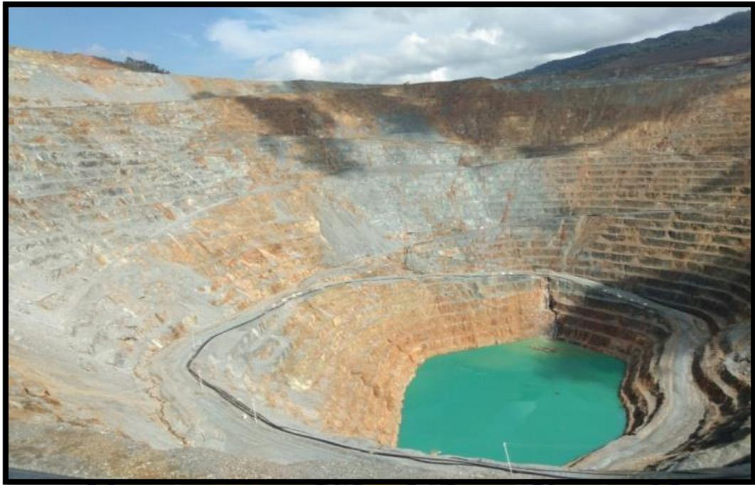
Gambar 2.9. Sistem Penambangan *Open Pit* pada Batu Hijau
