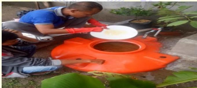
Gambar 2.4 Reaktor Digester
