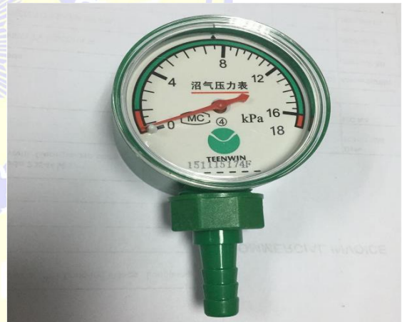
Manometer Sebagai Pengukur Tekanan
