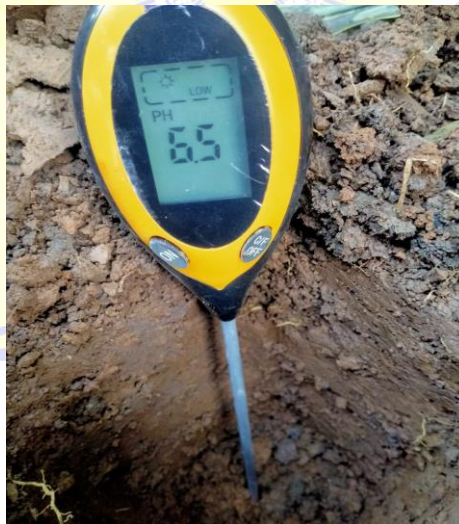
Pengujian pH Tanah Menggunakan pH Meter pada Lahan SONO KLI
