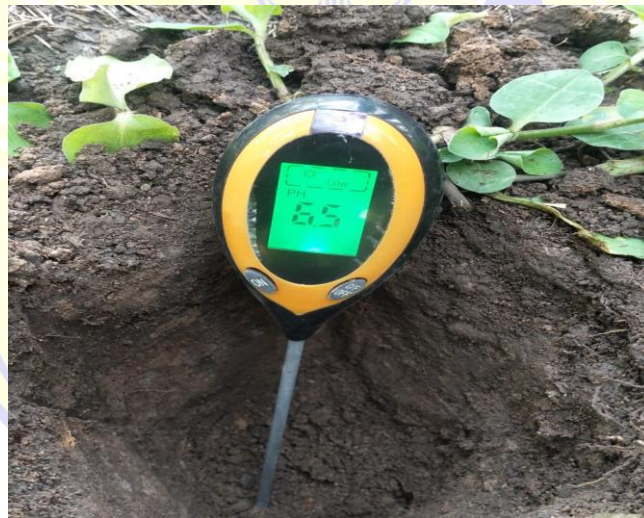
Pengujian pH Tanah Menggunakan pH Meter pada Lahan DUWE LA AJI
