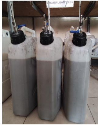
Digester P2 (kotoran sapi)
