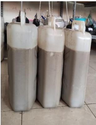
Digester P4 (campuran kotoran sapi, limbah ampas tahu dan limbah pasar)
