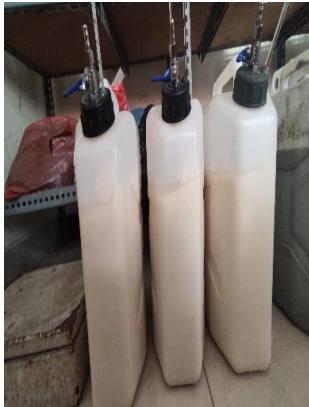
Digester P1 (limbah ampas tahu)
