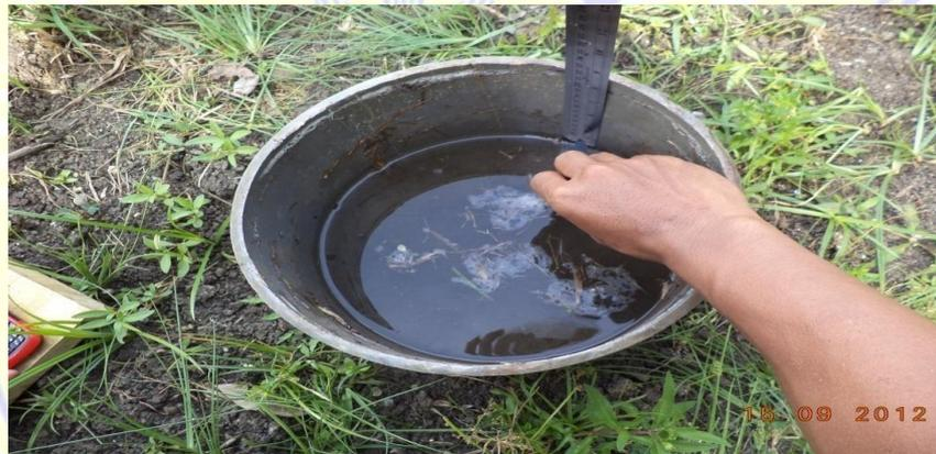
Gambar 1. Tabung infiltrometer sederhana
