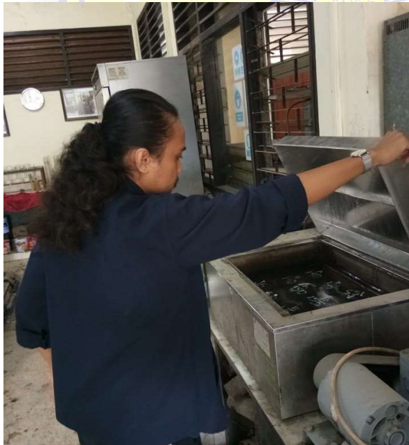
Gambar 4. Perendaman Benda Uji dalam Waterbath
