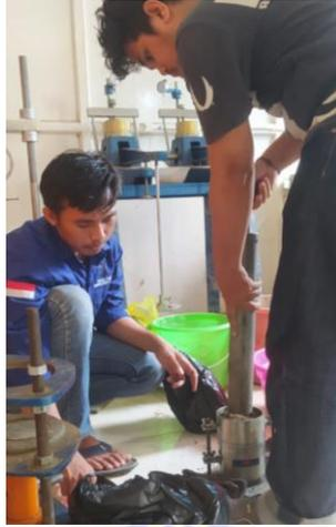
9. Lepas silinder penghubung (silinder atas), kemudian gunakan pisau arde (straight edge) agar permukaan tanah sejajar dengan permukaan silinder, bila perlu lubang-lubang kecil di tanah ditambal agar permukaan menjadi kembali. harus lebih halus. Lepaskan pelat dasar, kemudian timbang silinder ke tanah dan catat beratnya (W2).
