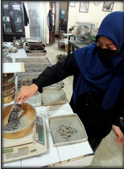
Proses perancangan Job Mix untuk pembuatan benda uji
