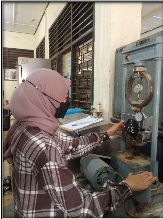
Proses Pengujian Marshall
