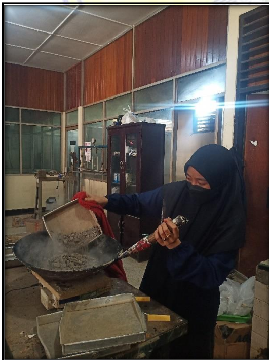
Proses pencampuran Aspal dengan Fresh Agregate
