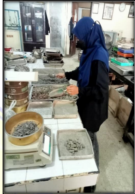
Proses perancangan Job Mix untuk pembuatan benda uji
