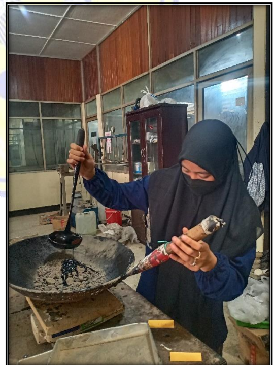
Proses pencampuran Aspal dengan Fresh Agregate
