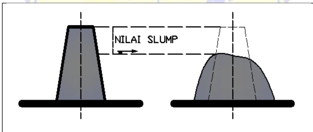
Gambar Sketsa beton segar saat pengukuran slumnya
