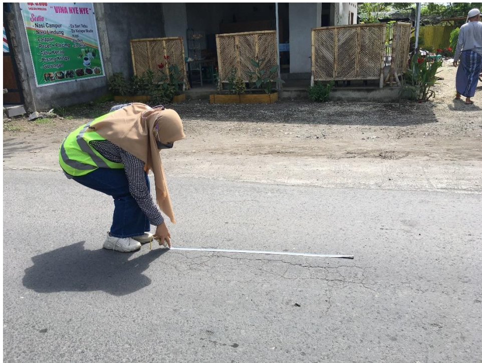
Gambar pengambilam data kerusakan
