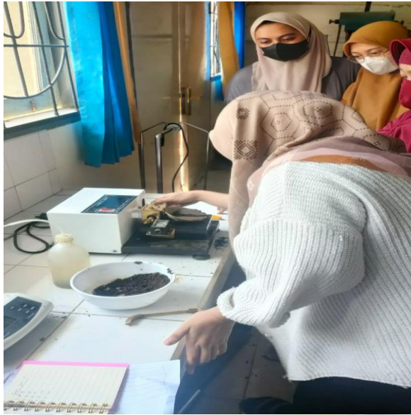
Pengujian Batas Susut
