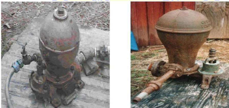
Gambar 1. Hidraulic ram pump pada awalnya (Calhoun, 2013)
