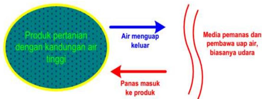
Gambar 3. Gambar prinsip dasar pengeringan
