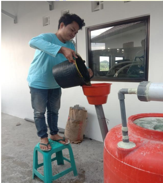
Penuangan Kotoran Sampi Dan Sampah Organik Rumah Tangga Ke Dalam Digester Biogas Portabel Untuk Di Fermentasi Menjadi Biogas
