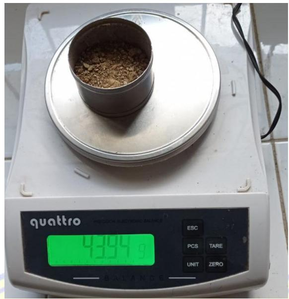
Dokumentasi penimbangan berat tanah kering pada uji kadar air tanah asli
