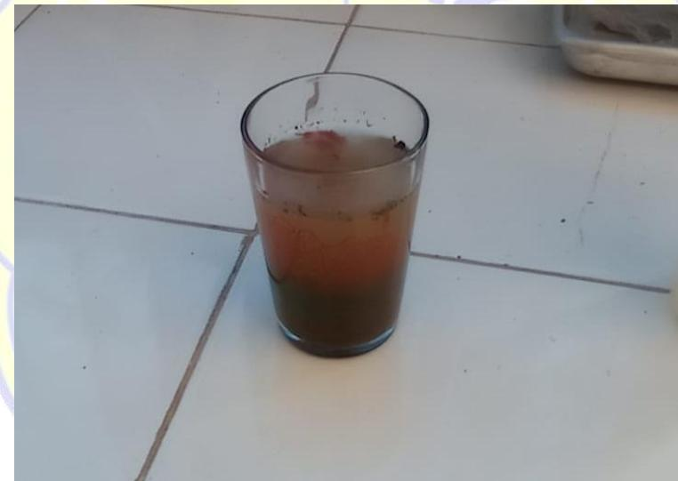
Dokumentasi campuran air dengan cairan kimia pelarut pada uji analisa hidrometer
