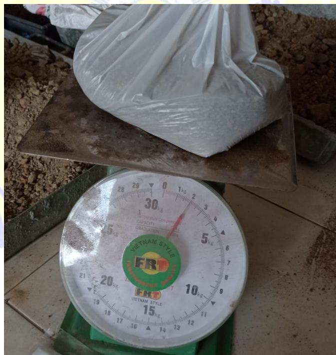
Dokumentasi penimbangan sampel uji pemanjatan sebelum didiamkan selama 24 jam agar tercampur dengan sempurna dengan kadar air rencana
