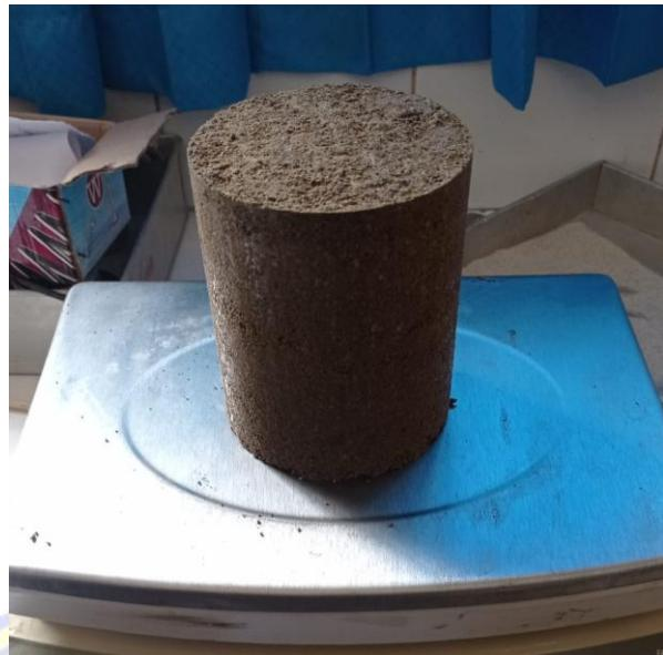
Dokumentasi proses penimbangan benda uji untuk mendapatkan nilai berat tanah padar setelah dikeluarkan dari silinder cetakan pada uji pemandatan tanah
