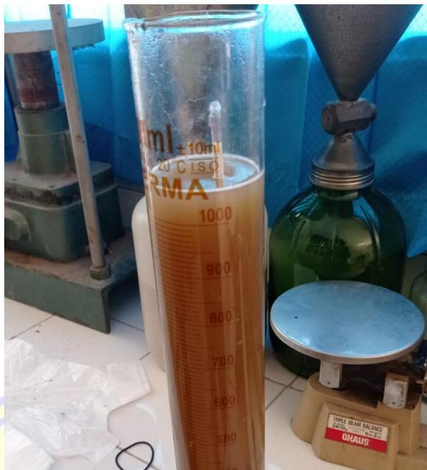
Dokumentasi pembacaan data analisa hidrometer menggunakan alat hidrometer
