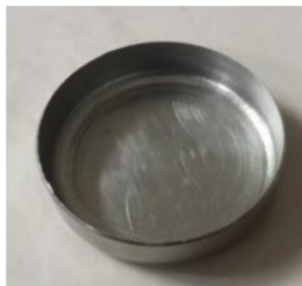
Gambar 3.22 cawan batas susut
