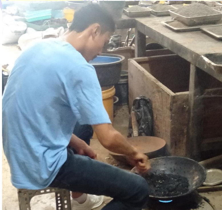
Dokumentasi Penambahan Air Aquadem Pada Pengujian BJ Agregat
