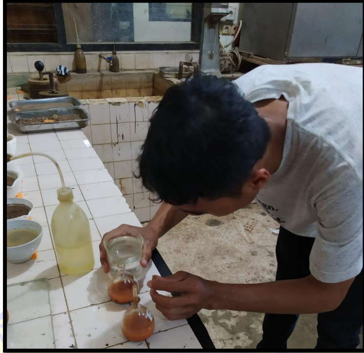
Dokumentasi Penambahan Air Aquadem Pada Pengujian BJ Agregat
