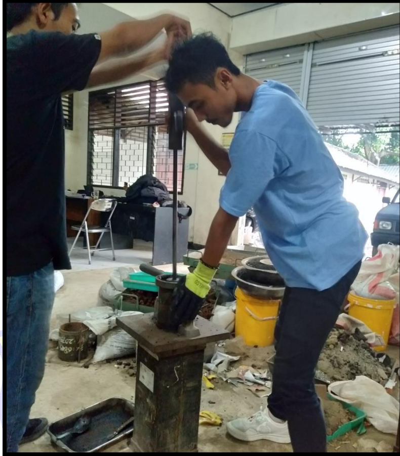
Dokumentasi Proses Penumbukkan Benda Uji
