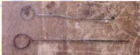
Gambar 3.15. Batang penyulut api
