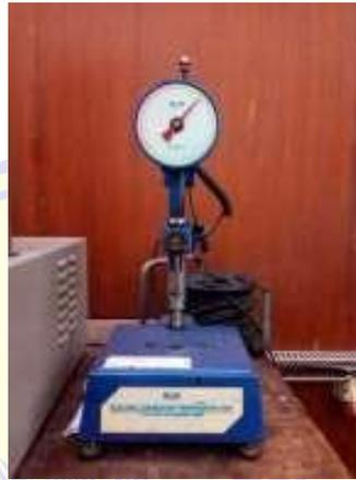
Gambar 3.4. Penetrometer
