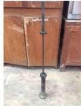
Gambar 3.19. Penumbuk benda uji
