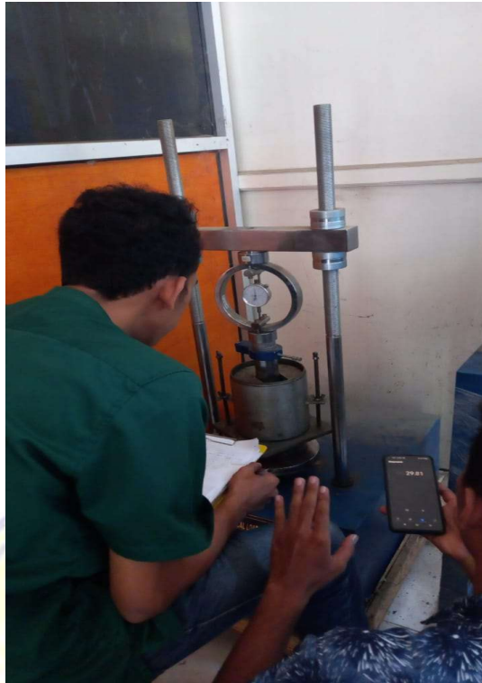
Pembacaan Arlogi Pada Pengujian CBR
