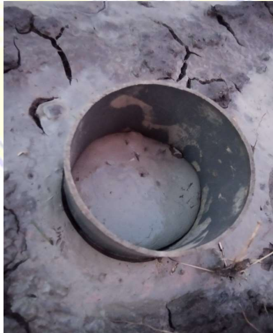
Pengujian Berat Isi Tanah
