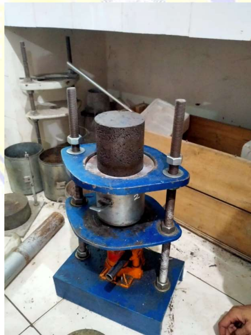
Prosen Mengeluarkan Sampel Tanah Pada Uji Pematatan
