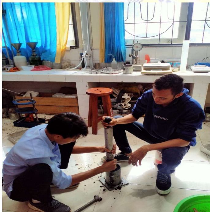
Pengujian Pemadatan Standar Proctor
