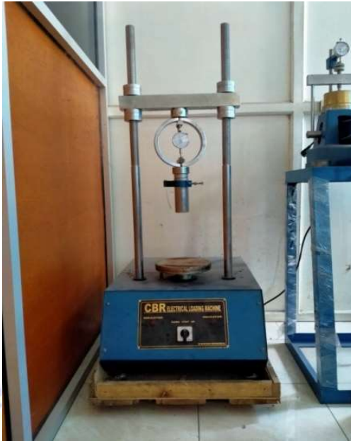
Gambar 3.26 Alat uji penetrasi CBR laboratorium
