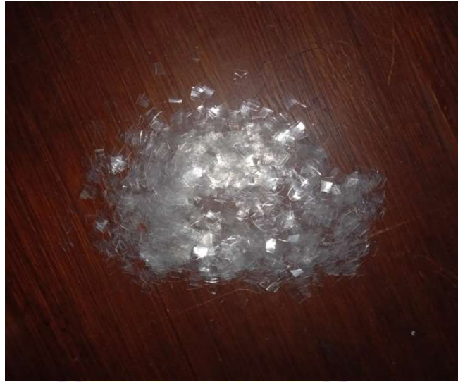
Gambar 3.5 Serat fiber dengan potongan 5x5 mm
