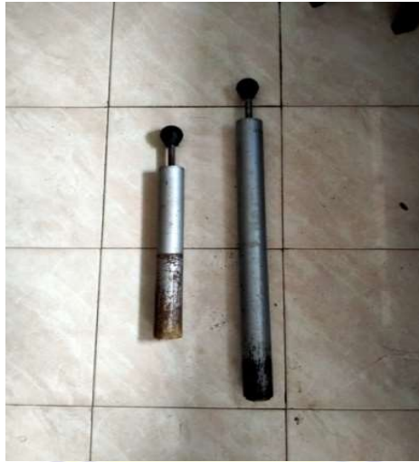
Gambar 3.10 Alat penumbuk (a). Standar Proctor (b). CBR
