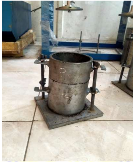
Gambar 3.12 Alat cetakan pepadatan standar Proctor
