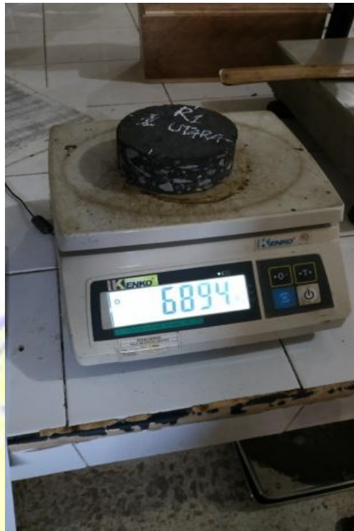
Gambar 6. Menimbang berat udara sampel
