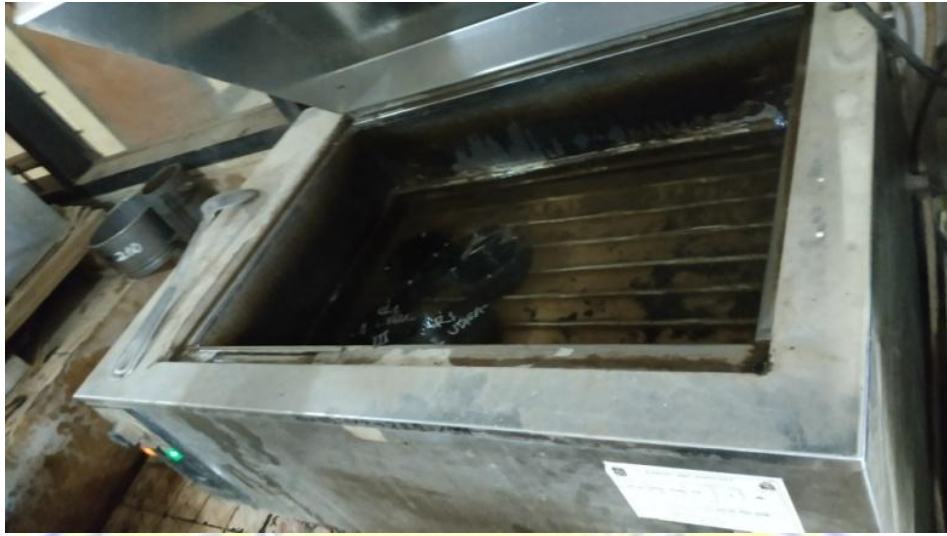
Gambar 10. Perendaman sampel dalam water bath
