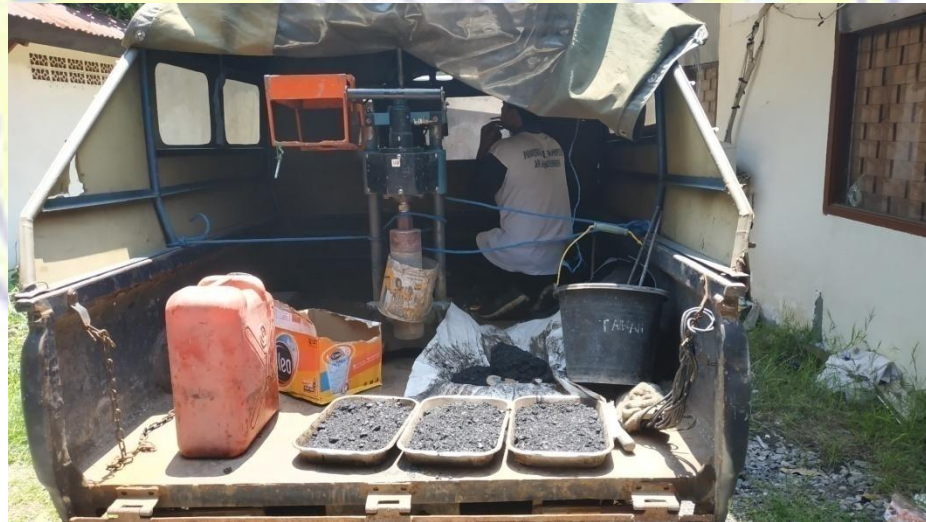
Gambar 4.1. Persiapan alat untuk mengambil sampel benda uji
