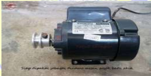
Gambar 18. Dinamo \frac{1}{2} hp (motor listrik)
