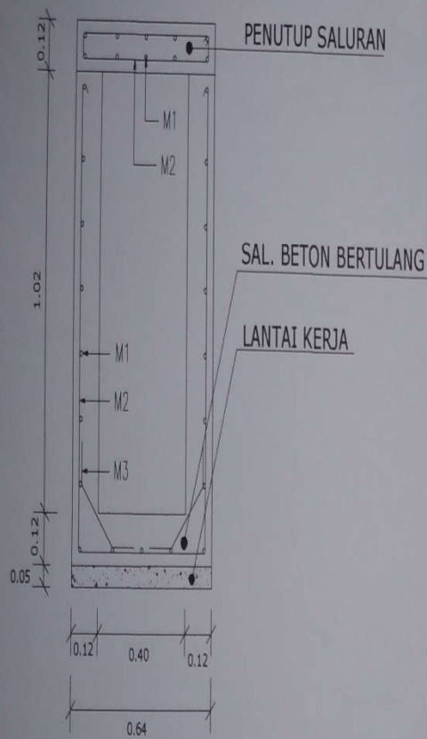
DETAIL SALURAN RUAS A13 SKALA 1:25
