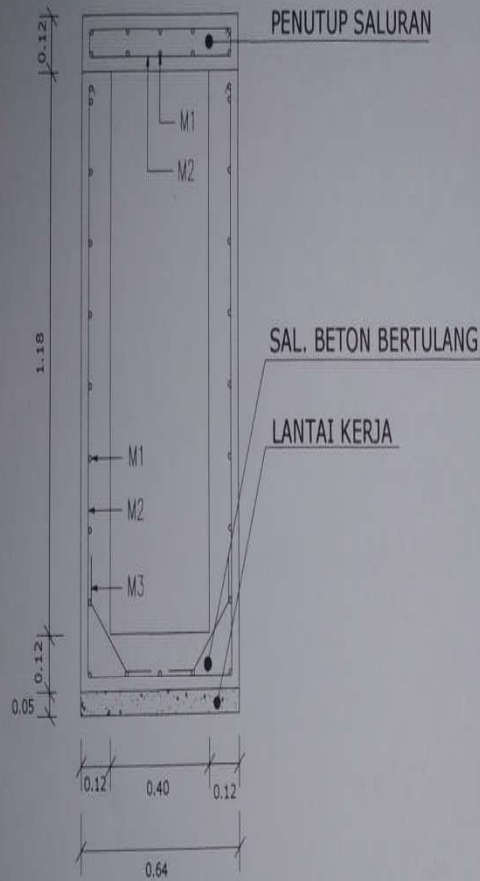
DETAIL SALURAN RUAS A7 SKALA 1:25
