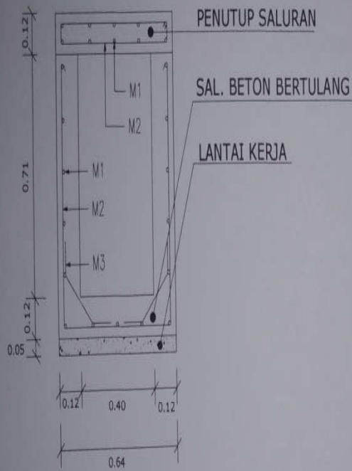
DETAIL SALURAN RUAS A11 SKALA 1:25
