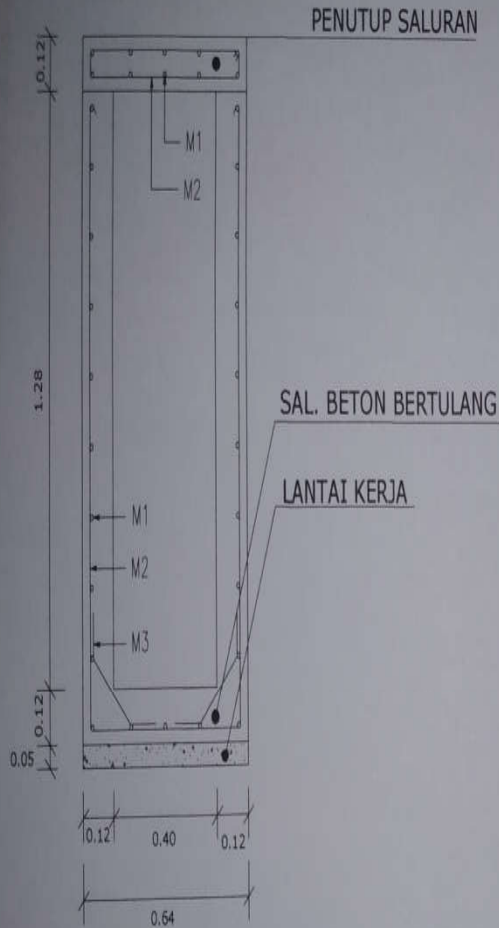
DETAIL SALURAN RUAS A3 SKALA 1:25
