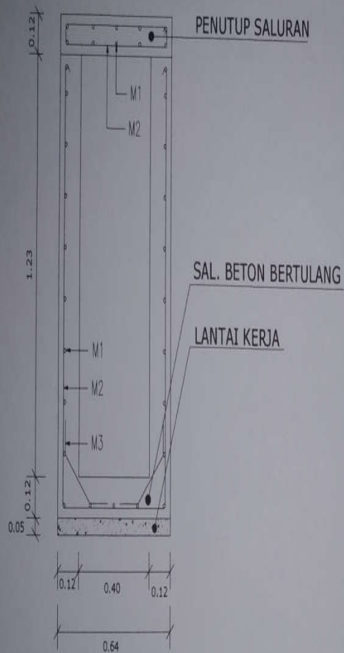
DETAIL SALURAN RUAS A5 SKALA 1:25
