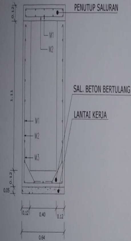
DETAIL SALURAN RUAS A1 SKALA 1:25
