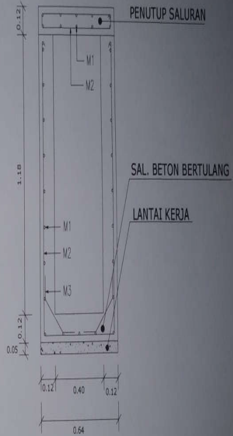
DETAIL SALURAN RUAS A8 SKALA 1:25
