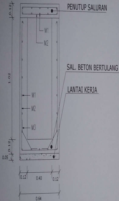
DETAIL SALURAN RUAS A15 SKALA 1:25
