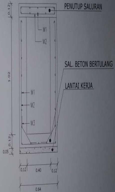
DETAIL SALURAN RUAS A12 SKALA 1:25
