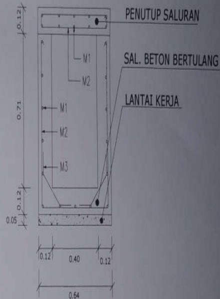
DETAIL SALURAN RUAS A10 SKALA 1:25
