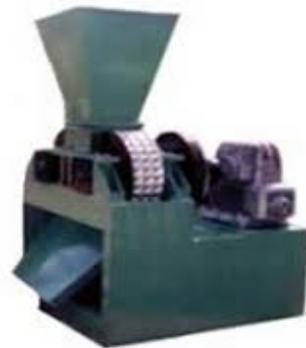
Gambar 4. Mesin Pembuat Briket
