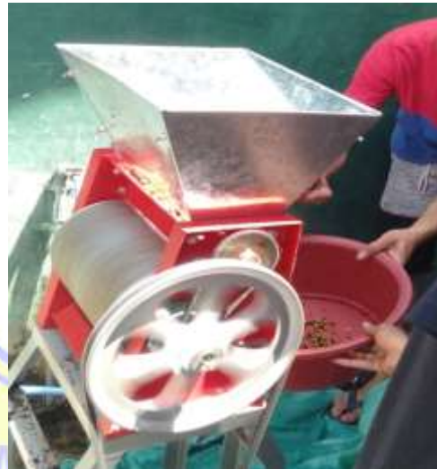
Penampungan Biji Cabai Yang Keluar Dari Alat Pengupas
