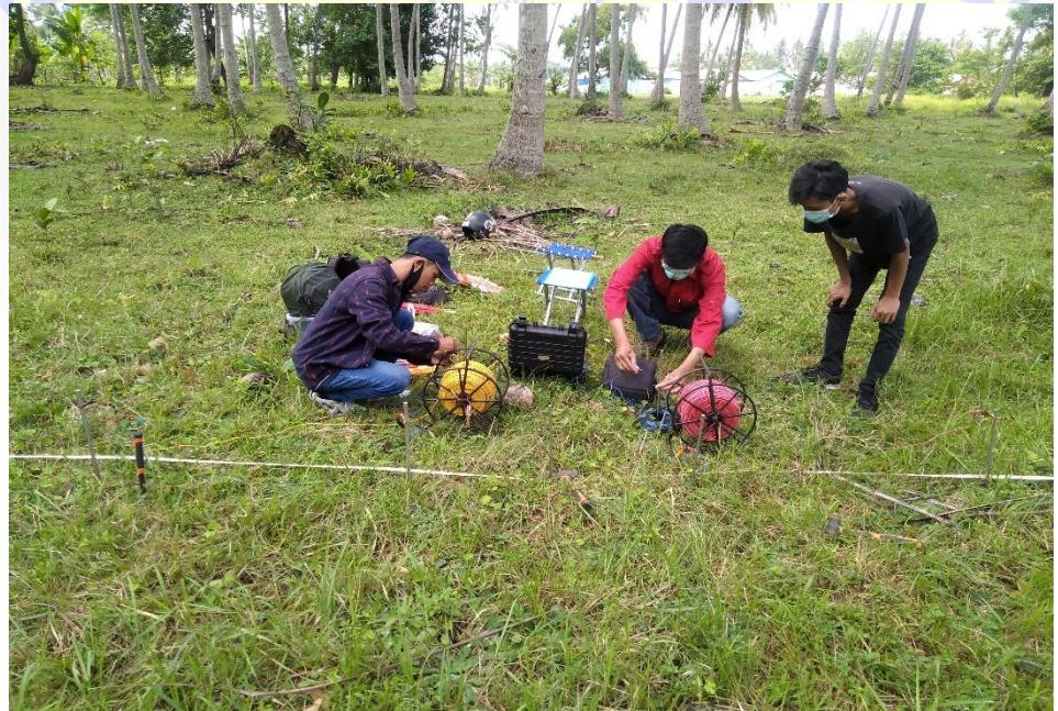
Hubungkan instrumen ke kabel elektroda
