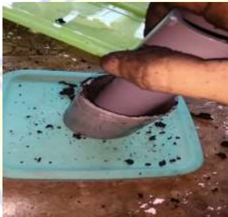
Proses pencetakan Briket arang
