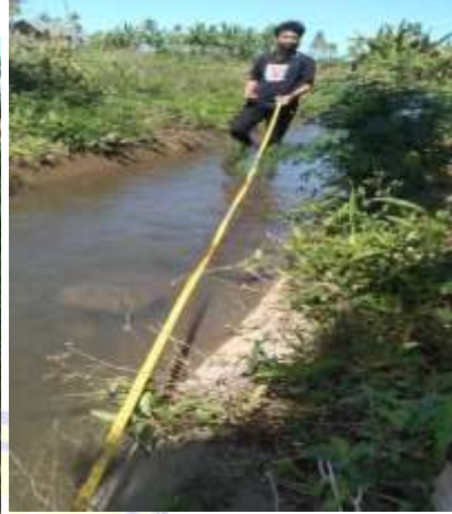
Mengukur Panjang Saluran
