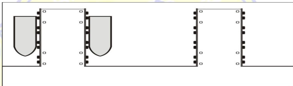
Gambar 2.2 Bentuk Dermaga Jenis Jetty/Pier
