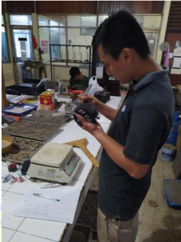
Pengukuran Tebal Benda Uji
