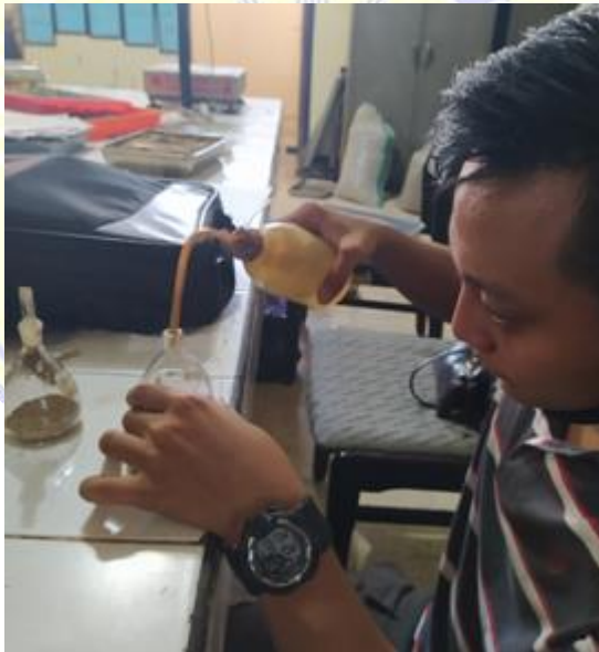
Uji BJ pada Filler Fly Ash
