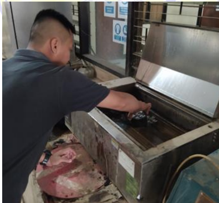
Perendaman Benda Uji dalam Water Bath dengan Suhu 60°C
