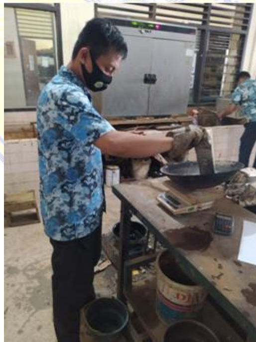
Penimbangan Agregat Setelah di Oven
