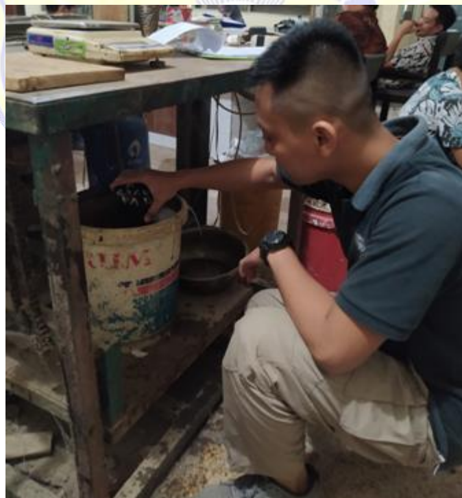
Penimbangan Benda Uji dalam Air
