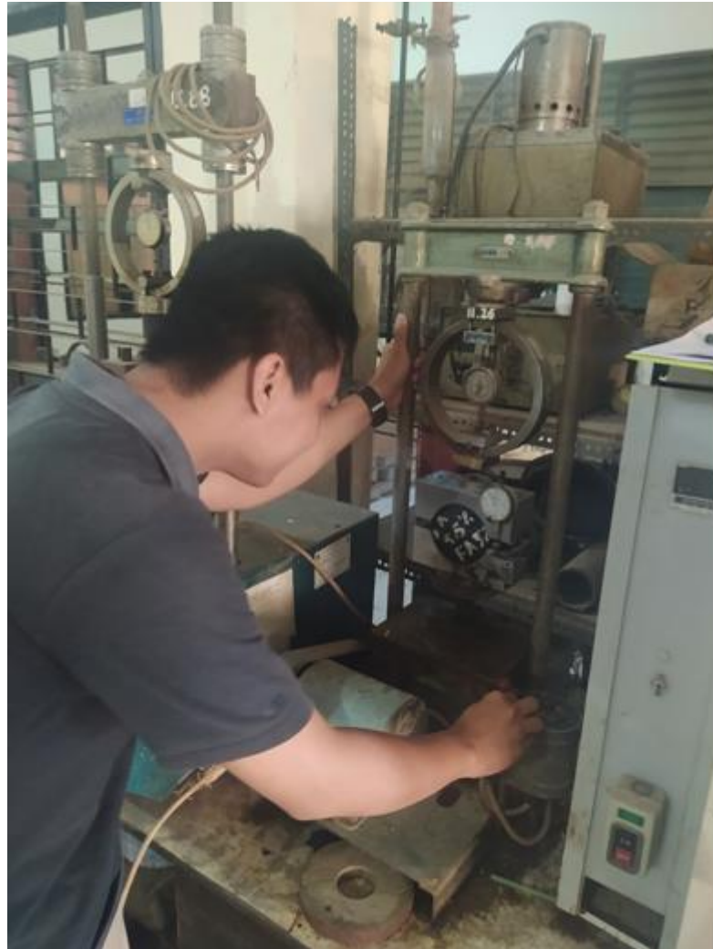
Proses Uji Marshall pada Benda Uji
