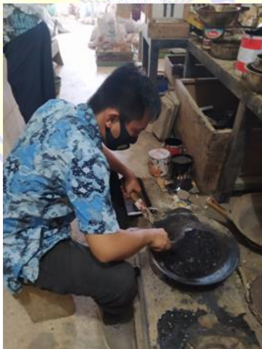
Penggorengan Campuran Agregat dengan Aspal
