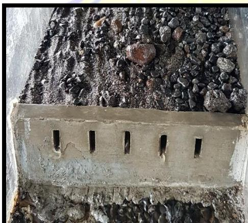
Memasang sabo dam pada flume
