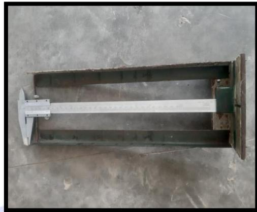
Jangka sorong alat untuk mengukur dasar kedalaman dasar dan elevasi muka air
