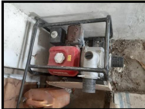
Pompa air untuk mengaliri air dari sungai hingga flume untuk eksperimen melakukan eksperimen
