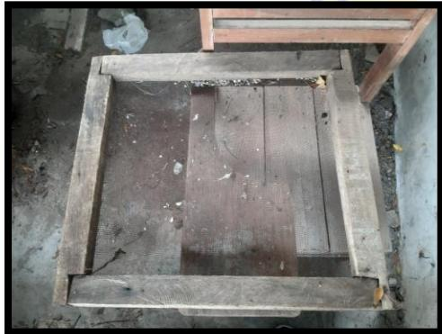
Saringan halus untuk menahan sedimen yang lolos dari flume
