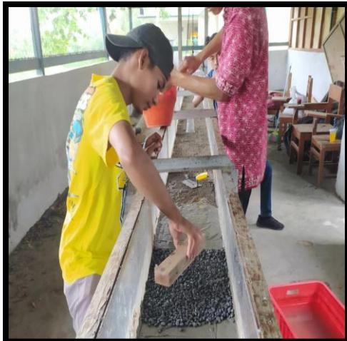
Mempersiapkan flume untuk melakukan eksperimen (memasang dasar tetap)
