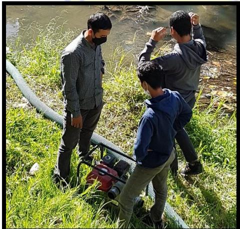
Menyalan mesin pompa air untuk mengaliri air pada flume 50, 100, 150, 160, dan 200 cm<sup>2</sup>/s
