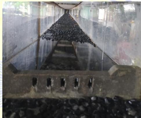
Mematikan mesin air dan melakukan pengukuran elevasi dasar flume
