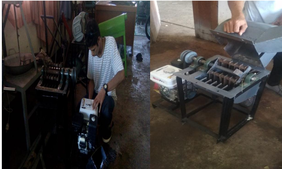
Pemasangan mesin motor penggerak
