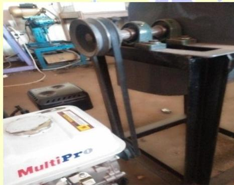
Gambar 17. Unit Transmisi.
