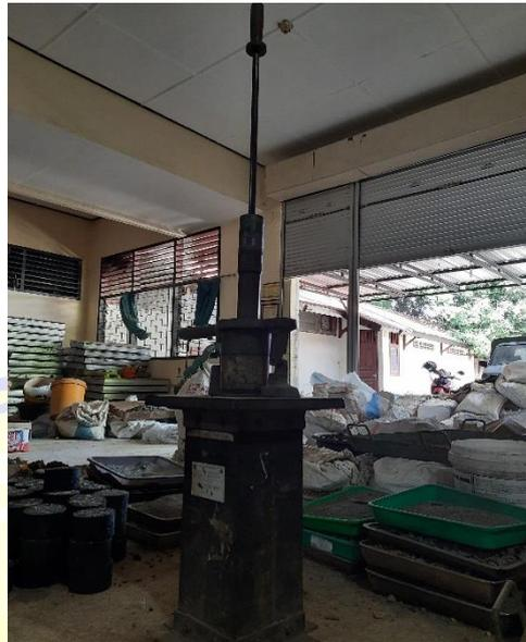
Gambar 3.7 Alat penumbuk (*compactor*)
