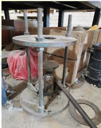
Gambar 3.8 Alat pengangkat *briket* ( dongkrak hidrolis )
