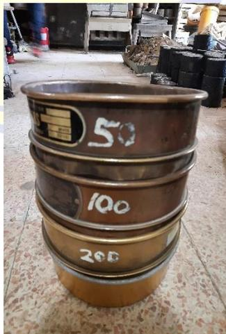
Gambar 3.1 Satu set alat uji saringan standar ASTM.
