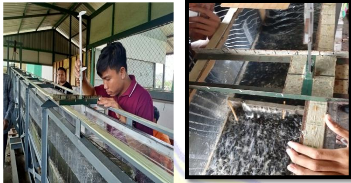
Gambar 3.10 Uji Dasar Flume Tidak Tetap
