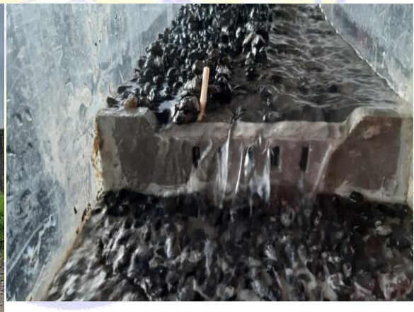
Gambar 10. Model Sabo dam dalam eksperimen di laboratorium hidrolika Teknik Sipil Universitas Muhammadiyah Mataram
