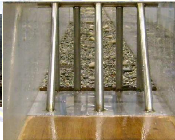
Gambar 4. Model Sabo dam tipe terbuka dalam eksperimen di laboratorium teknik sipil Kyushu University, Jepang
