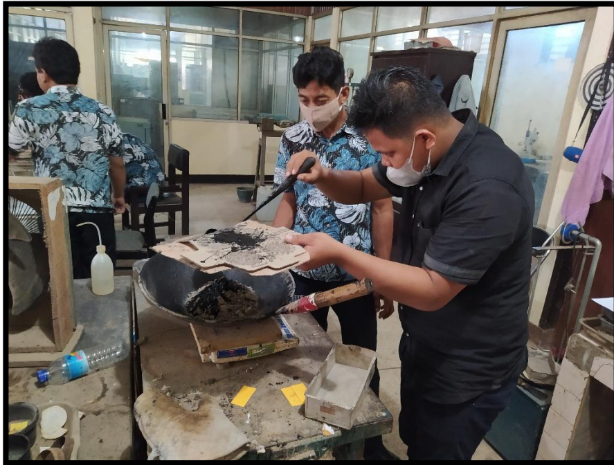
Dokumentasi Proses Penambahan Aspal Pada Campuran
