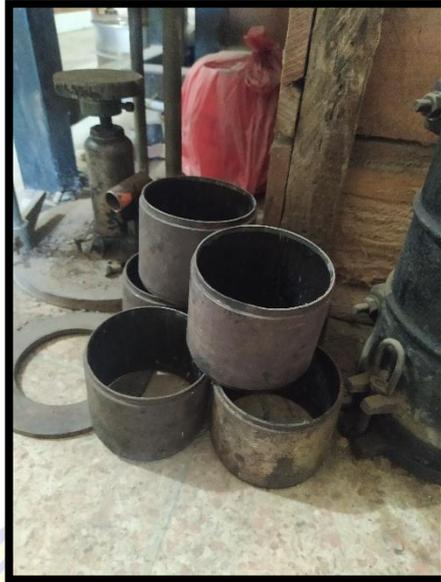
**Gambar 3.5** Cetakan Benda Uji (*Briket*)
