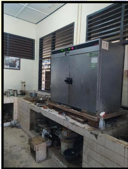
**Gambar 3.2** Oven atau pemanas agregat
