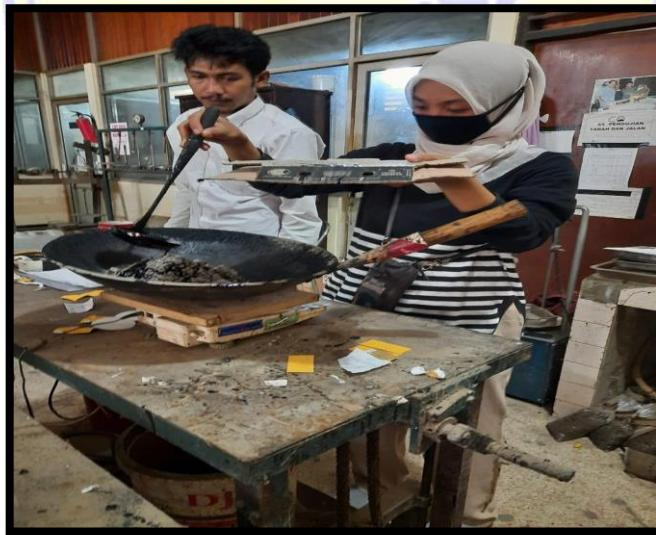
Proses pencampuran aspal dengan *fresh aggregate*
