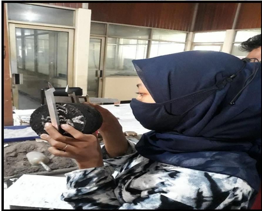
Proses pengukuran tebal benda uji
