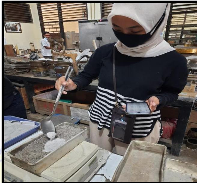
Proses perancangan job mix untuk pembuatan benda uji
