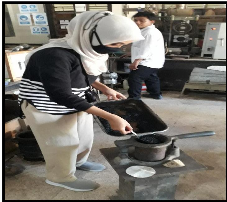
Hasil campuran aspal dan agregat di tuang ke dalam *mould*
