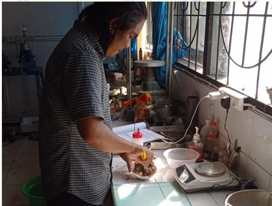
Dokumentasi pencampuran sampel uji tanah batas plastis dengan air suling setelah sebelumnya sampel tanah ditimbang kurang lebih 15 gr – 20 gr
