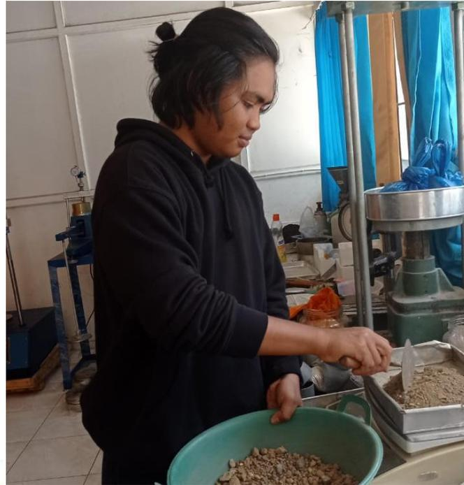
Dokumentasi persiapan sampel tanah untuk pengujian analisa saringan
