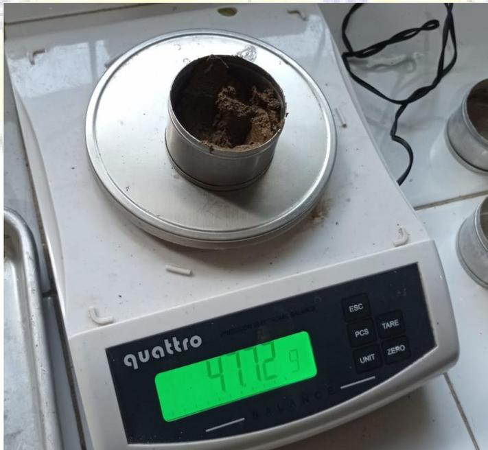
Dokumentasi penimbangan sampel tanah uji batas cair untuk mendapatkan berat cawan + tanah basah
