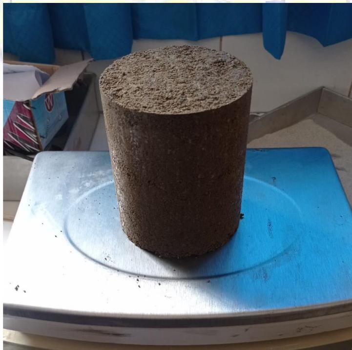
Dokumentasi proses penimbangan benda uji untuk mendapatkan nilai berat tanah padar setelah dikeluarkan dari silinder cetakan pada uji pemadatan tanah
