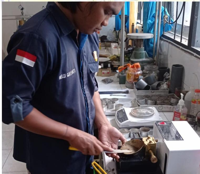
Dokumentasi perataan sampel uji pada alat cassagrande sebelum dilakukan uji pukulan
