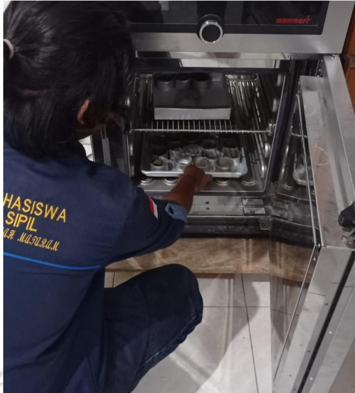
Dokumentasi uji batas cair tanah pada proses memasukkan sampel tanah uji basah yang telah ditimbang untuk dikeringkan dalam oven
