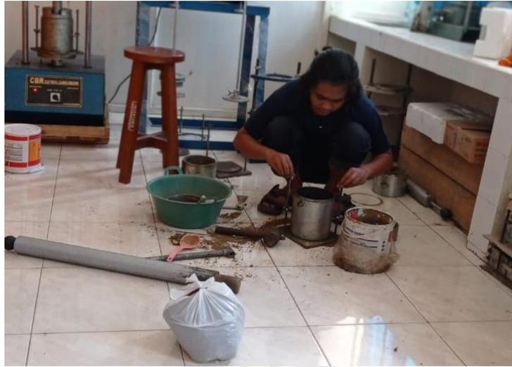
Dokumentasi uji CBR pada saat memasukkan sampel tanah uji yang telah dicampur kadar air optimum yang didapatkan pada uji pemdatan
