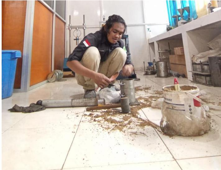
Dokumentasi proses memasukkan sampel tanah kedalam cetakan untuk dilakukan penumbukan pada uji pemadatan tanah
