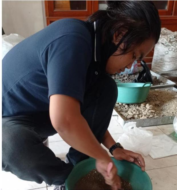
Dokumentasi uji pemadatan tanah pada saat proses mencampur benda uji dengan kadar air rencana
