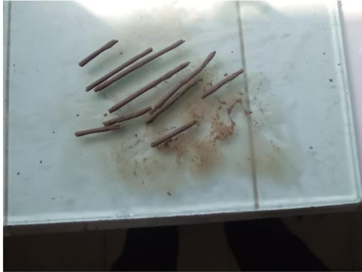
Dokumentasi sampel tanah uji batas plastis yang telah di giling hingga seukuran 3 mm
