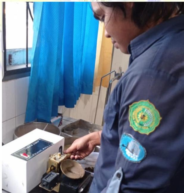
Dokumentasi uji batas cair tanah pada saat melakukan melakukan pukulan pada sampel tanah menggunakan alat cassagrande
