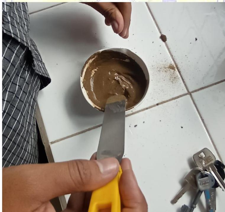
Dokumentasi uji batas susut pada saat mencampur sampel tanah dengan air suling
