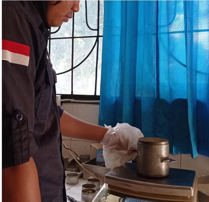
Dokumentasi penimbangan sampel uji dengan silinder guna mendapatkan berat silinder + tanah padat
