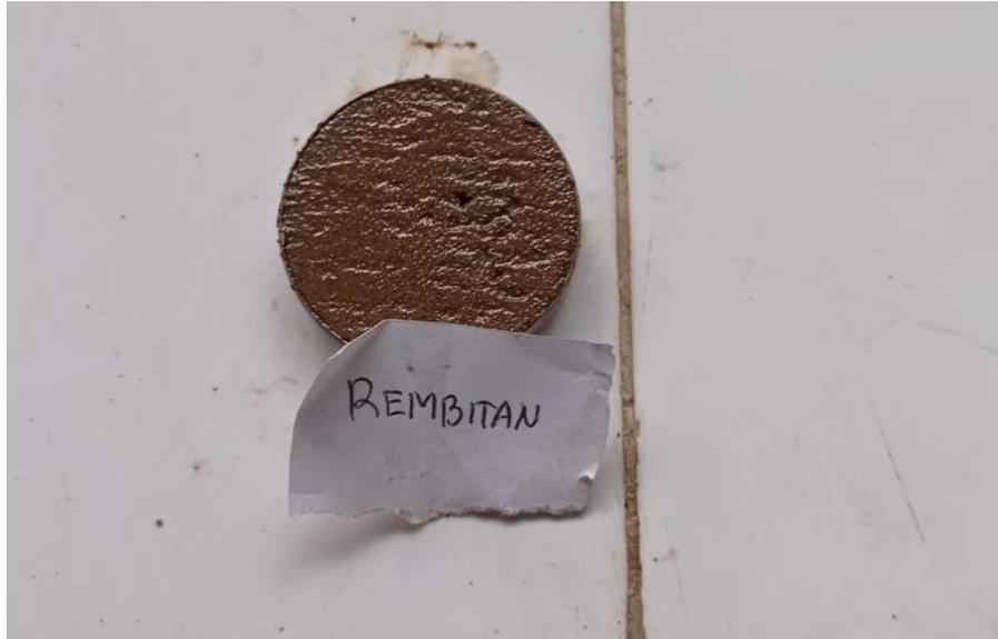
Dokumentasi benda uji batas susut yang telah dimasukkan kedalam cawan untuk di oven
