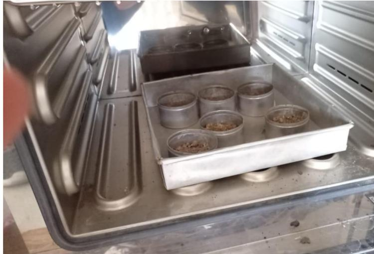
Dokumentasi pengeringan sampel tanah basah pada uji kadar air tanah asli
