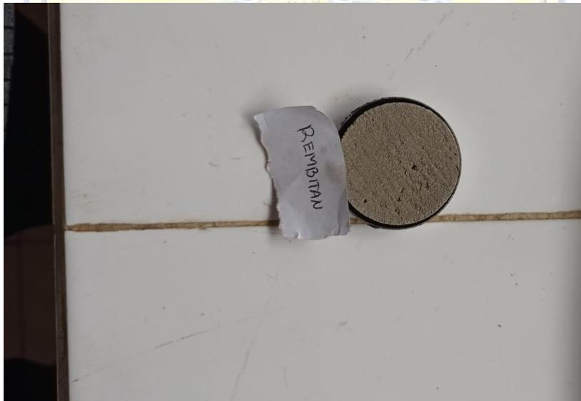
Dokumentasi salah satu sampel benda uji batas susut setelah proses pengeringan menggunakan oven
