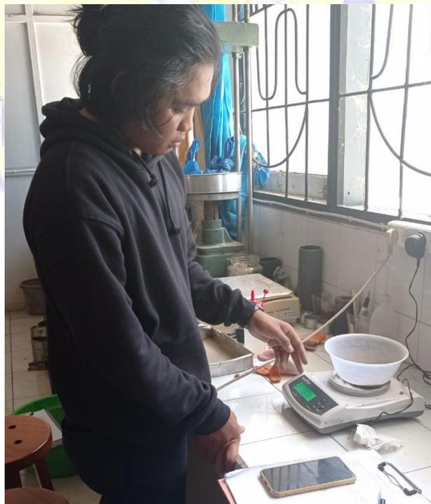
Dokumentasi proses penimbangan sampel tanah dan pencatatan data hasil uji saringan
