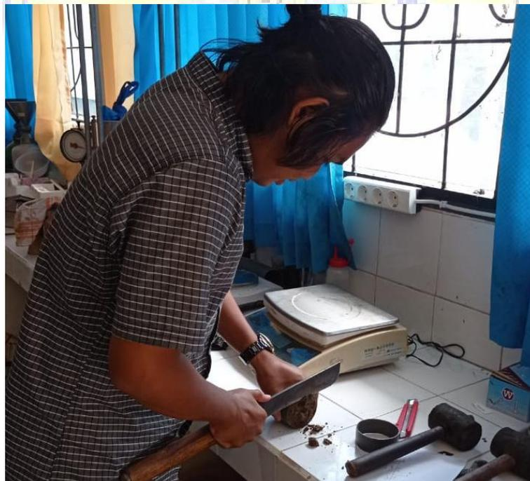
Dokumentasi uji berat volume tanah pada saat perataan permukaan tanah pada benda uji
