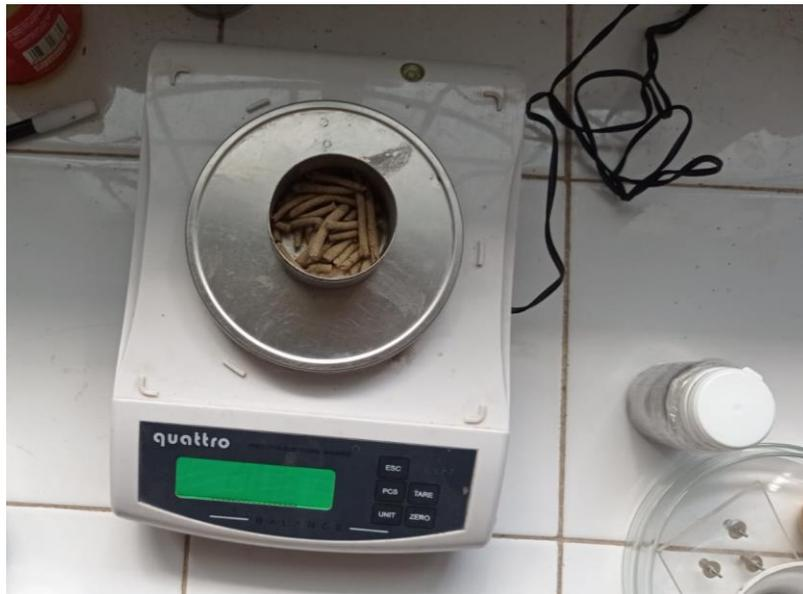
Dokumentasi proses penimbangan sampel uji tanah batas plastisitas untuk mendapatkan berat cawan + tanah kering
