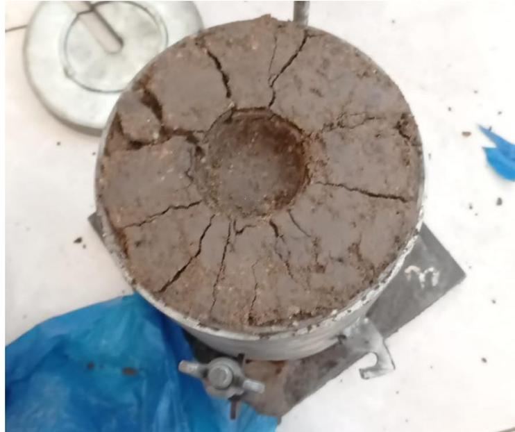
Dokumentasi sampel tanah setelah dilakukan uji CBR yang setelahnya akan dikeluarkan dari cetakan silinder dan diambil sampel tanah untuk di keringkan menggunakan oven
