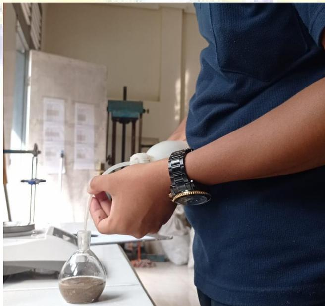
Dokumentasi uji berat jenis pada saat memasukkan air suling kedalam piknometer berisi tanah sampel
