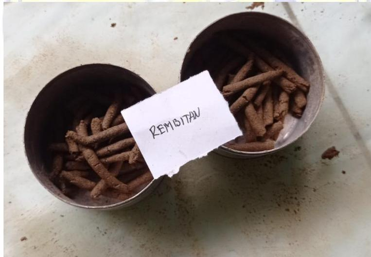
Dokumentasi sampel tanah uji batas plastis sebelum ditimbang untuk mendapatkan berat cawan + tanah basah dan dikeringkan untuk mendapatkan berat cawan + tanah kering
