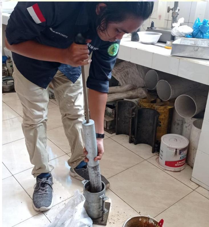
Dokumentasi proses penumbukan sampel tanah pada uji pemadatan
