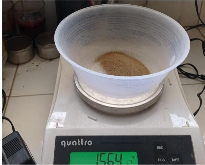
Dokumentasi ampel tanah hasil uji analisa saringan yang akan digunakan dalam analisa hidrometer
