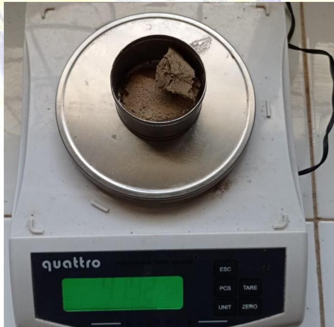
Dokumentasi penimbangan sampel tanah uji batas cair yang telah dikeringkan menggunakan oven untuk mendapatkan berat tanah kering + cawan
