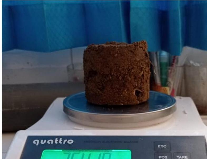
Dokumentasi penimbangan sampel uji berat volume dilakukan penimbangan sampel tanah volume basah sebelum di ambil sebagian untuk di keringkan didalam oven untuk mendapatkan volume kering.
