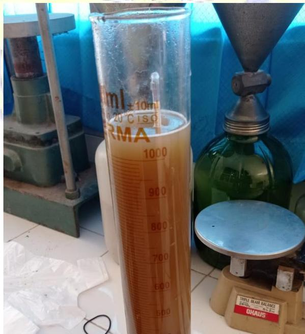
Dokumentasi pembacaan data analisa hidrometer menggunakanalat hidrometer 152 H
