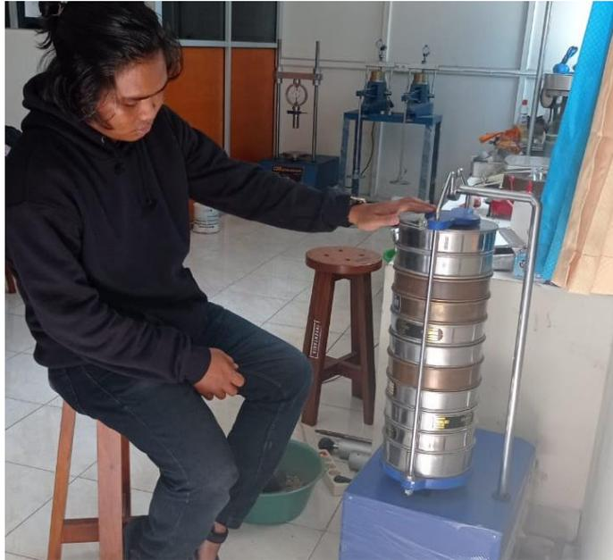
Dokumentasi proses pengayakan sampel tanah uji saringan menggunakan alat *sleve shaker*
