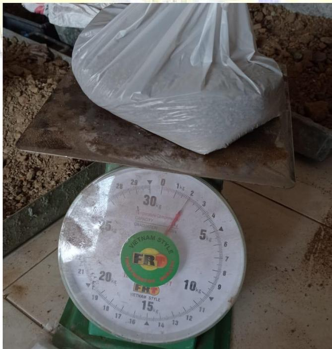
Dokumentasi penimbangan sampel uji pemadatan sebelum didiamkan selama 24 jam agar tercampur dengan sempurna dengan kadar air rencana
