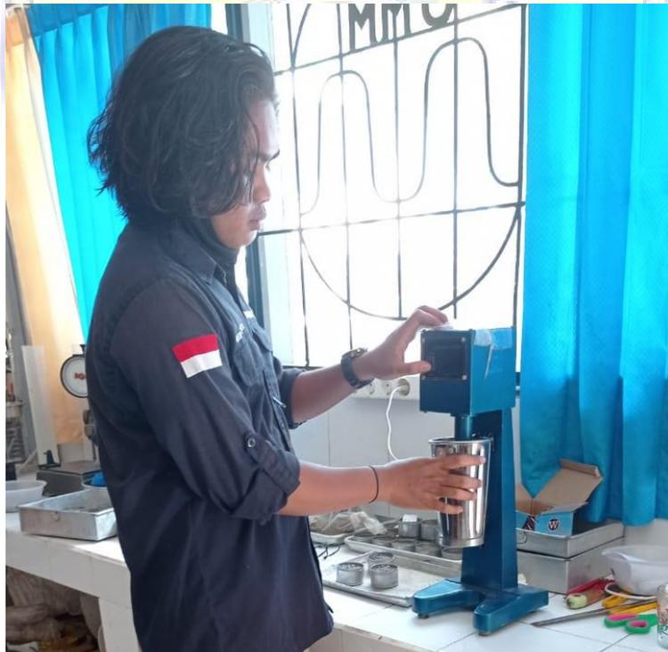
Dokumentasi sampel tanah analisa hidrometer dilakukan proses mixer setelah di jenuhkan selama 24 jam
