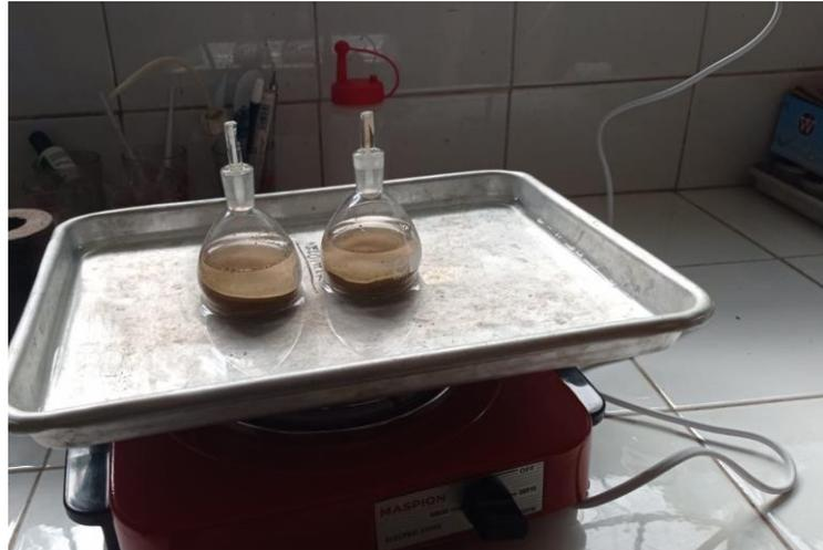
Dokumentasi uji berat jenis pada saat proses pemasakan sampel tanah dengan campuran air suling agar mengeluarkan sisa-sisa gelembung udara yang terperangkap dalam sampel tanah
