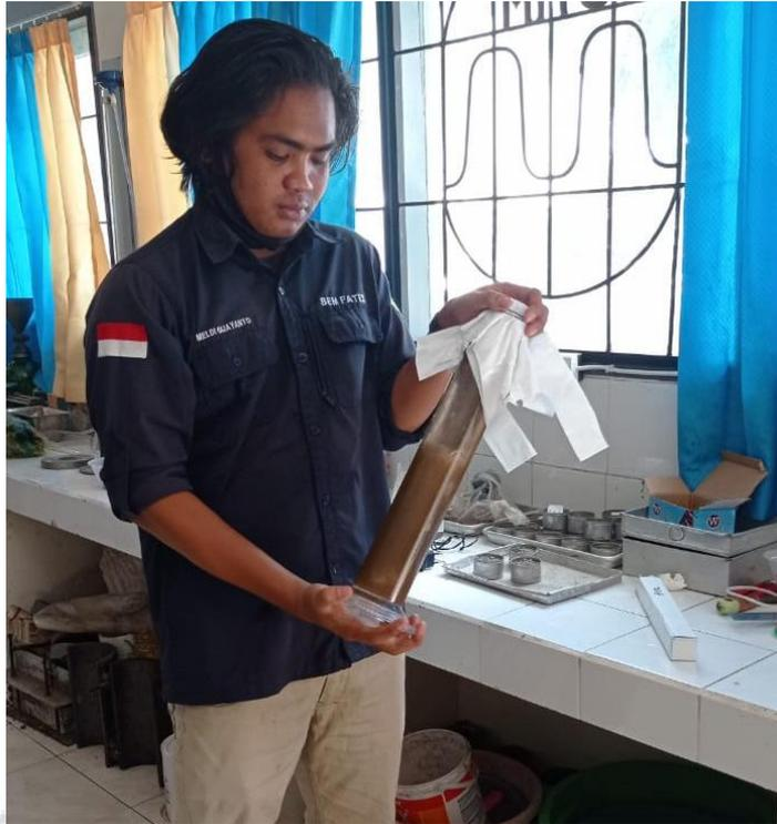
Dokumentasi pengocokansampel tanah yang telah di mixer selama 2 menit pada uji analisa hidrometer
