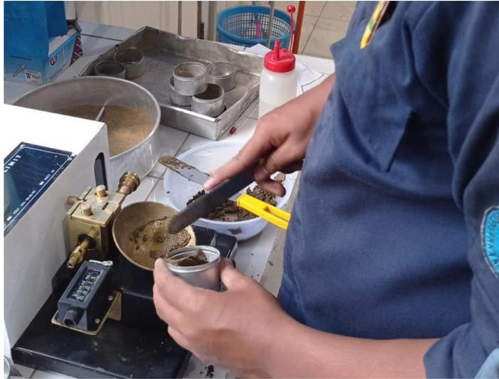
Dokumentasi uji batas cair pada saat memasukkan sampel tanah yang selesai dilakukan pukulan untuk di timbang agar mendapatkan berat cawan + tanah basah
