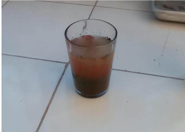
Dokumentasi campuran air dengan cairan kimia pelarut pada uji analisa hidrometer sebelum di jenuhkan selama 24 jam
