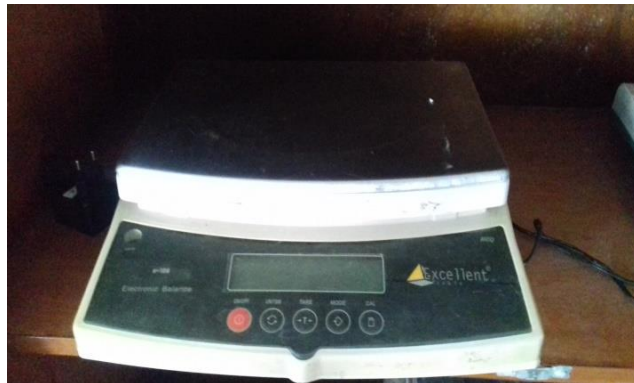
Gambar 3.9 Timbangan ketelitian 0,1 gram
