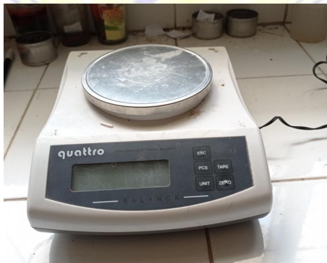
Gambar 3.8 Timbangan ketelitian 0,01 gram
