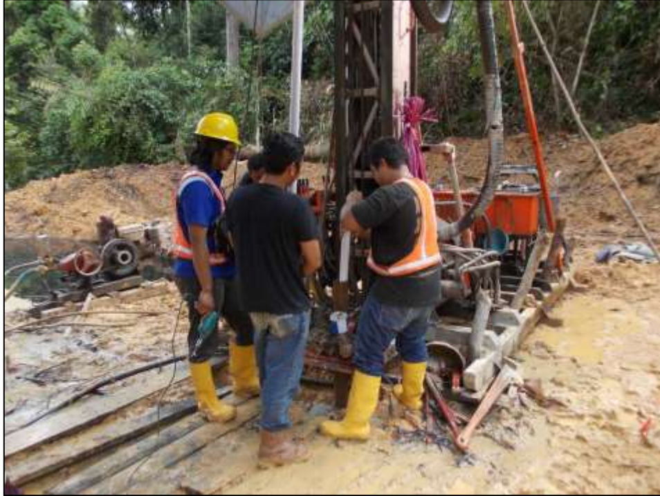
Pengambilan sampel UCS untuk pengujian laboratorium
