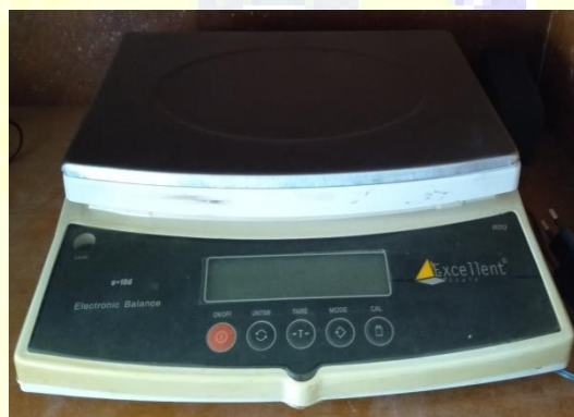
Gambar 3.4 Timbangan dengan ketelitian 0,1
