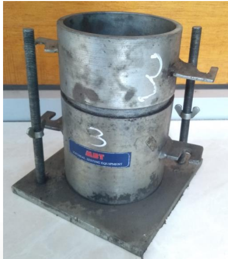
Gambar 3.8 Alat cetakan uji pemadatan standar proctor
