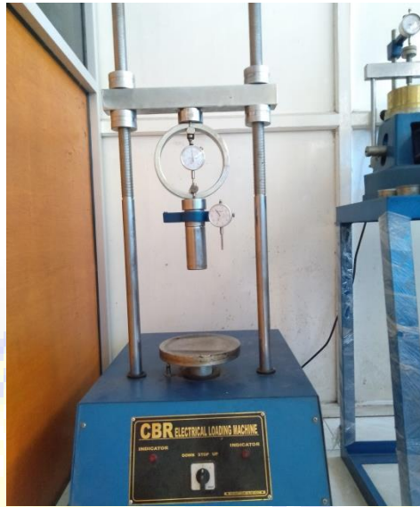
Gambar 3.18 Alat uji penetrasi CBR laboratorium
