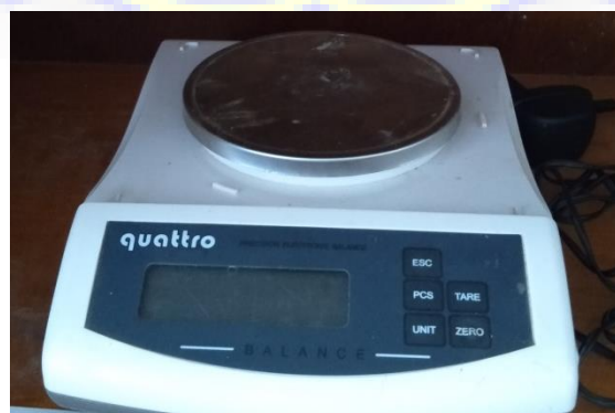
Gambar 3.5 Timbangan dengan ketelitian 0,01
