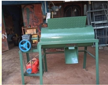
Gambar 22. Mesin Pengaduk Pakan Ternak Unggas
