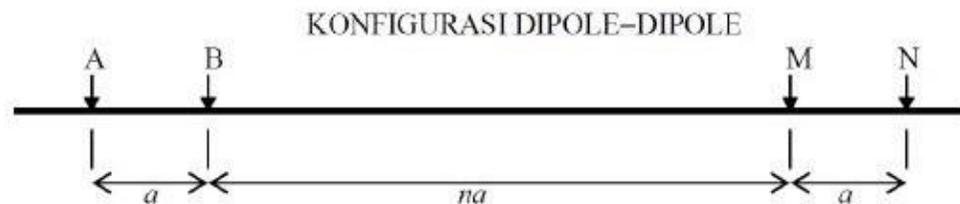
Gambar 2.5 Konfigurasi Dipole-Dipole.
